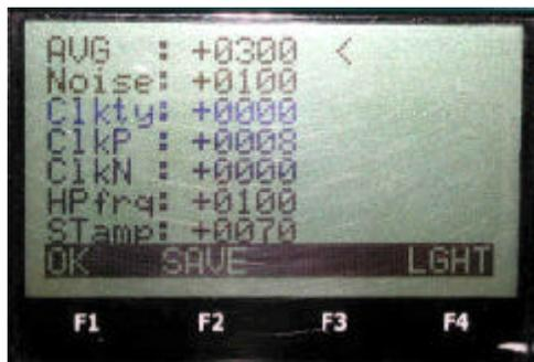
Con il dispositivo EchoLab, oltre a scegliere il protocollo desiderato (TEOAE o DPOAE), possiamo modificarne i singoli parametri
